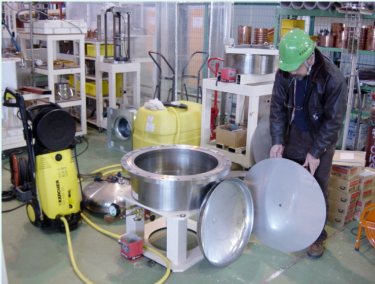
\phi 600, 1.5 t SUS 316L End Shell for Helium Vessel
