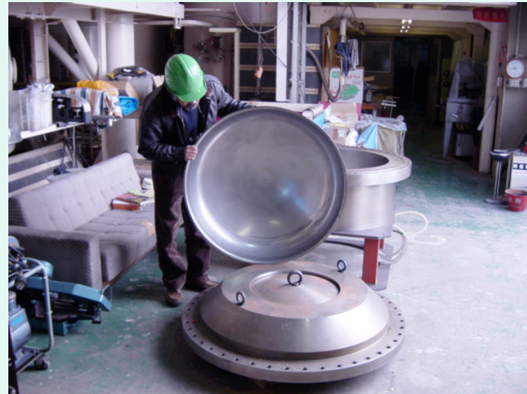
\phi 920, 2 t SUS 316L End Shell for Helium Vessel
