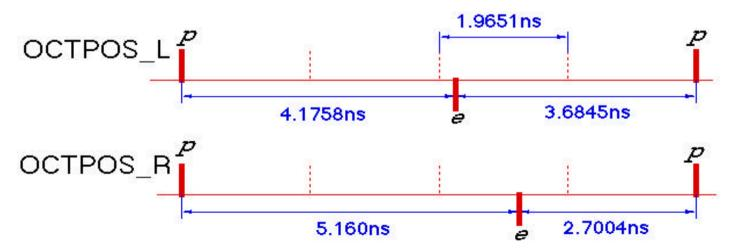
Lside  $\pi/4$  @508Mhz,  $\pi/2$  @1019MHz Rside  $\pi/4$  @508Mhz,  $\pi/2$  @1019MHz
