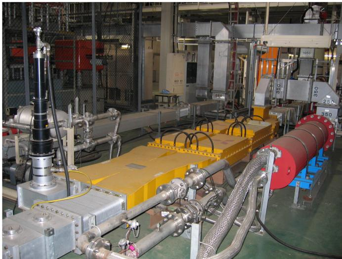
1.2MW CW klystron
