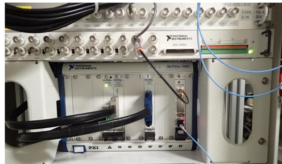
今回の開発により、VMEだけでなくPXIのEVRが使えるようになった(databufferの受信、trigger出力)
