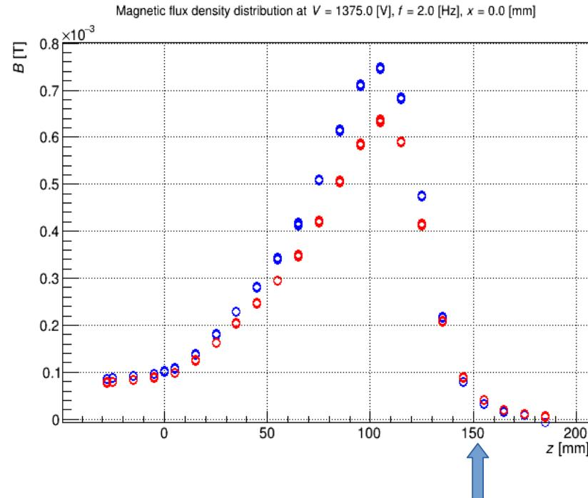
MRダクト磁性体部をセパタム導体板の端から150mm程度延ばす セパタム導体板の端
